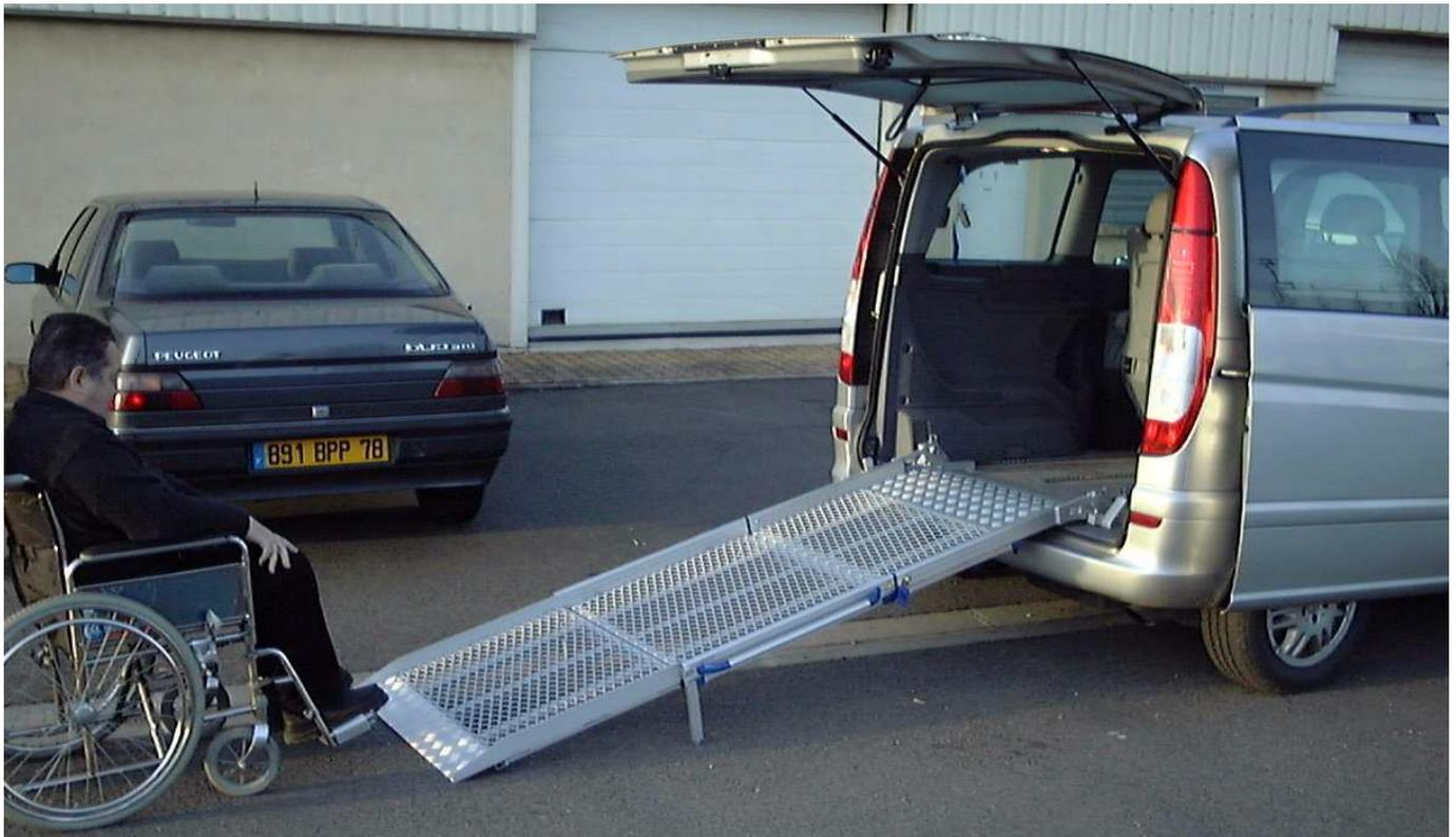
**Ces rampes, en aluminium, ont un traitement de surface qui offre une excellente prise et rend simple le chargement et le déchargement, en toute sécurité.**
